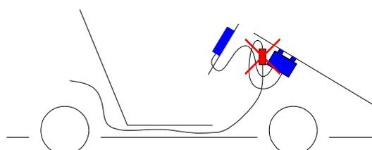
Le module du capteur RPM NE DOIT PAS être installé près du BOX.
