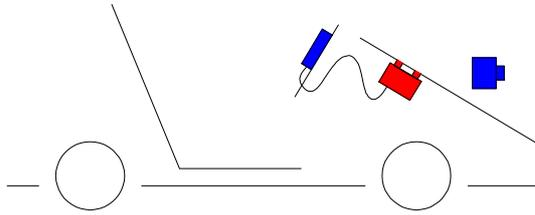
Le BOX4GPS et la caméra ou tout autre appareil électronique doivent être espacé de minimum 30cm/12inch pour une réception optimale des signaux GPS.
