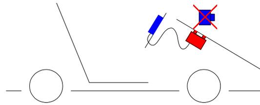
Lors d'une installation comme ci-dessus, la sensibilité des signaux GPS diminue de plus de 50%. Cela engendre un dysfonctionnement des prises de temps et un tracé de la trajectoire erroné.
