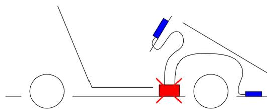
Le BOX ne peut pas être installé sur le plancher !
