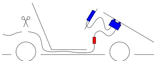
Le boîtier du capteur RPM doit être le plus éloigné possible du BOX. Le fin câble qui se raccorde sur le câble haute tension de l'allumage doit être installé seul, le plus éloigné possible des autres câbles. Si nécessaire, coupez le câble pour une installation linéaire.
